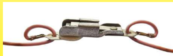
Limitatore di temperatura per coperte Calor a rottura lenta, calibrato a 80°C (1960 circa). Si noti la guaina impermeabile in PVC saldata sui fili e l'anello formato dai conduttori elettrici che passano attraverso un foro in ogni terminale, per eliminare le tensioni di trazione sui fili (Ultimheat Collection).
