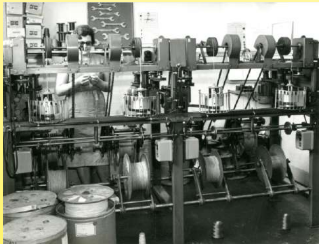
1960 ca. Officina di guipage per i cavi scaldanti utilizzati nelle coperte elettriche. (Ultimheat Museum)
