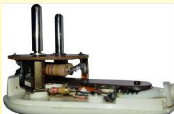
1972 ca. Centralina di controllo della potenza prodotta da Jidé a Limoges con il marchio Jidéstat. Il sistema di maggior successo. Di dimensioni molto ridotte, è regolabile e incorporata nella spina elettrica. È l'unico modello con contatto magnetico a scatto. È stato superato dai sistemi elettromeccanici solo nell'era attuale. (Ultimheat Collection)
