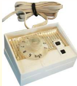
1970 ca. Regolazione della potenza GEC (General Electric, Inghilterra) su una coperta riscaldante inglese. La resistenza anticipata è chiaramente visibile sopra il bimetallo e l'interruttore lento (Ultimheat Collection).
