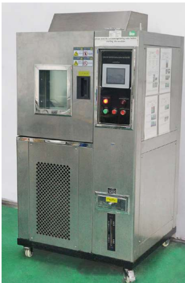
Camera climatica, con intervallo di regolazione della temperatura da -90 a +150^\circ C , intervallo di regolazione dell'umidità relativa da 1 a 100%.
