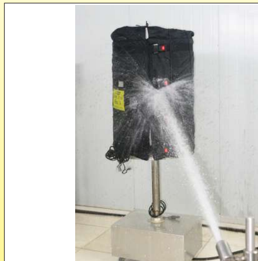
Test IPx6 dei riscaldatori a mantello
