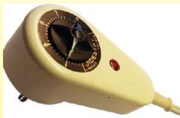
1972 ca. Centralina di controllo della potenza prodotta da Jidé a Limoges con il marchio Jidéstat. Il sistema di maggior successo. Di dimensioni molto ridotte, è regolabile e incorporata nella spina elettrica. È l'unico modello con contatto magnetico a scatto. È stato superato dai sistemi elettromeccanici solo nell'era attuale. (Ultimheat Collection)
