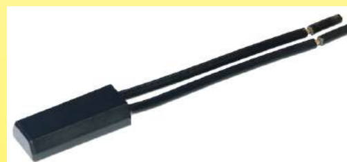
2019 Limitatore di temperatura a scatto per il riscaldamento transitorio, derivato dal modello 7AM della Texas Instruments del 1966, utilizzabile a 230V, in involucro impermeabile in plastica. Intervallo di temperatura da 5 a 8°C. Tipo V7AM. (Ultimheat Collection)
