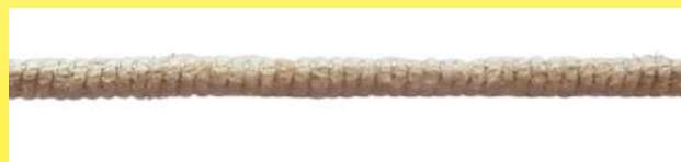
1960 ca. Cavo scaldante Calor, diametro 1.7 mm, filo scaldante singolo al nichel-cromo, diametro 0.08 mm, su un'anima di cotone leggermente attorcigliato per evitare che si pieghi. (Ultimatheat collection)
